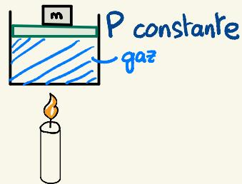
Comme  $V$  n'est pas constant, on a une partie de l'énergie qui est échangée sous forme de travail. Il s'agit du travail nécessaire à faire bouger le piston. On considère ici une transformation quasi-statique.
